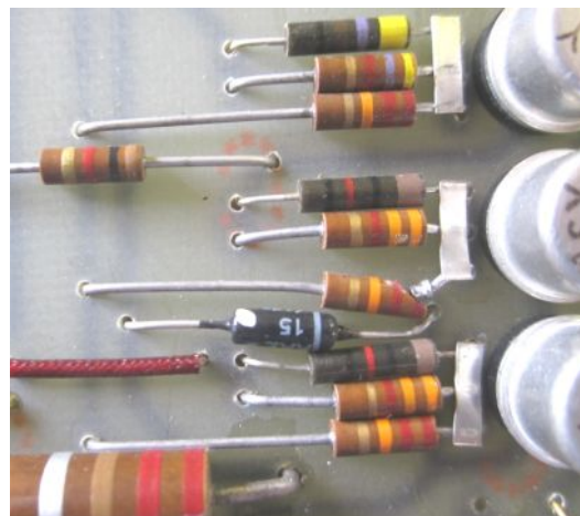
Ytterligare exempel på mekaniska skador
