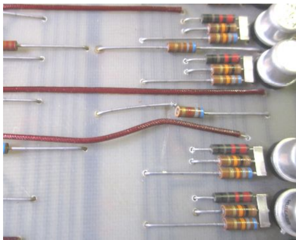
Exempel på mekaniska skador på kretskort
