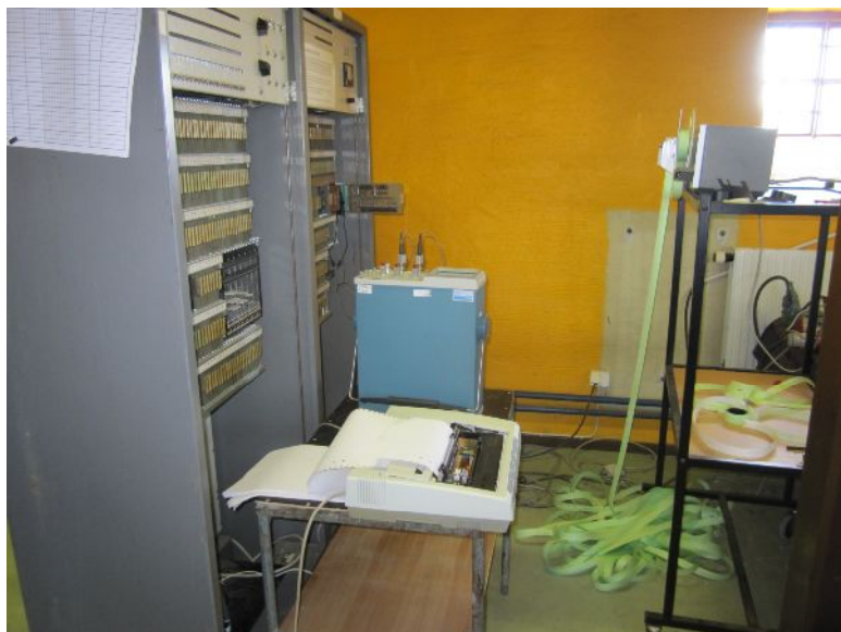
Inläsning av testprogram från hålremsa.
